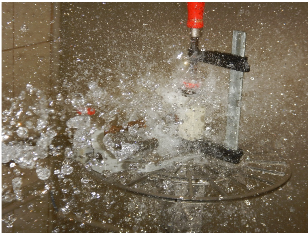
Bild 2 Exposition zur Schutzgradprüfung IP X6, Beispiel
