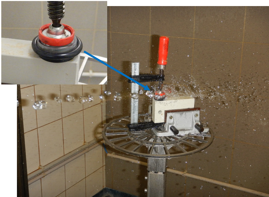
Bild 1 Exposition zur Schutzgradprüfung IP X5, Beispiel
